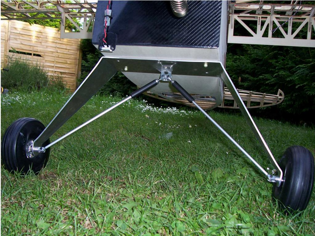
Als Fahrwerk am besten ein GFRK Teil von KHK verwenden. Das hier gezeigte Alufahrwerk wird nicht lange halten. Spurweite soll 550mm sein, Höhe ist ca. 240mm nötig. Auflage am Rumpf währe 100mm tief und 240mm breit. Räder für Hauptfahrwerk sollten mindestens 150mm Durchmesser haben.
