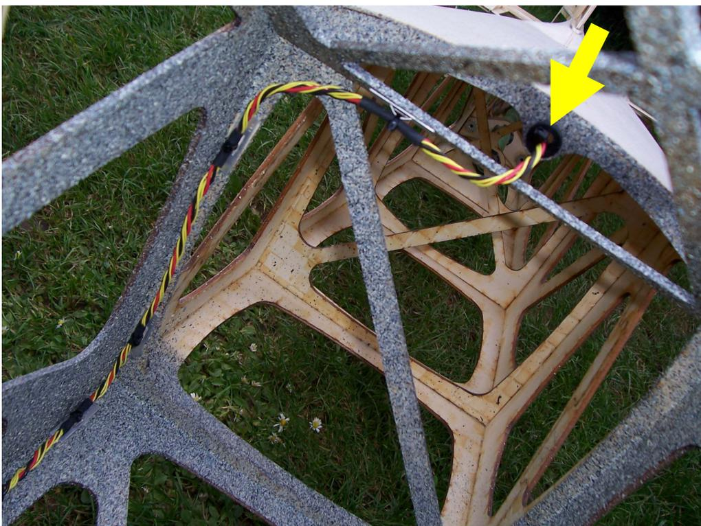
In diese Bohrungen (Pfeil) wird der Kabelstrang nach hinten gelegt.
