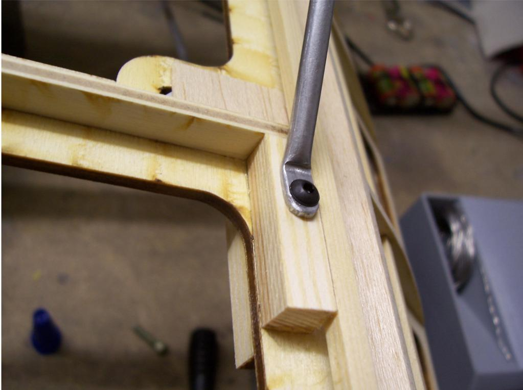
Am Höhenleitwerk und Seitenleitwerk Kieferleisten als Support anbringen und wie hier gezeigt am HR ein 8mm Alurohr am Ende Flach gedrückt mit M3 Schrauben durchschrauben.
