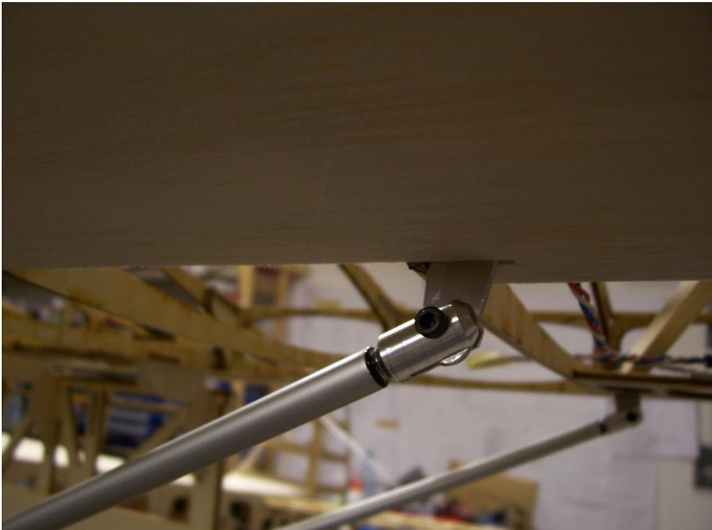
**Hier die Fläche von unten. Die hintere Strebe wird mit einem Aluwinkel befestigt. Die vordere wird mit dem vorher beschriebenen Alustreifen verschraubt. Als Strebenmaterial wird hier Alurohr aus dem Baumarkt verwendet. Durchmesser 10mm für die Flächenstreben.**
